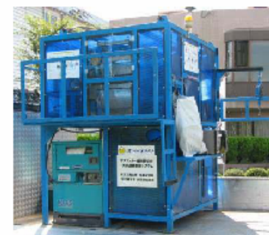
移動式連続固液分離装置 (APCユニット)
